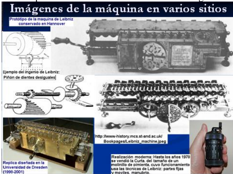
Figura 3. Imágenes de la máquina de Leibniz y de su sucesora Curta
